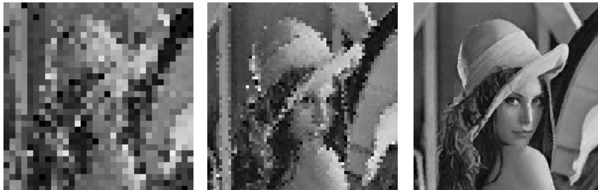
**Bild 1** Folge von rekonstruierten Bildern aus dem fraktalen Code nach einer, zwei und fünf Iterationen.
