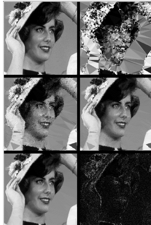
(b) Partitionnement R de la figure 3c. : taux de compression = 9,5:1 , RSB = 30 dB
