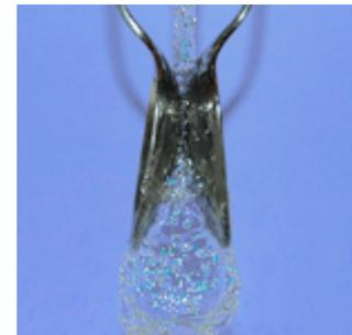
Die Löffel bewegen sich im Wasserstrahl aufeinander zu und klappen ständig aneinander. Das Klappern kann man auch hören (deswegen sollten Metalllöffel verwendet werden).
