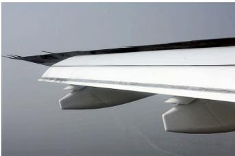
**Landeklappen an der Tragfläche eines Flugzeugs (nach unten)**
