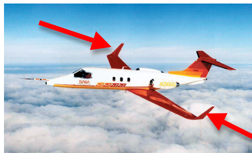
Winglets eines modernen Flugzeugs (rote Pfeile).
