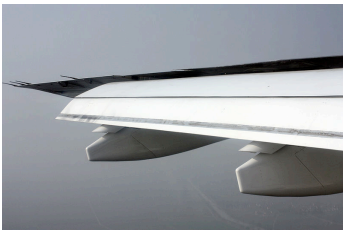
Landeklappen an der Tragfläche eines Flugzeugs (nach unten geklappt).
